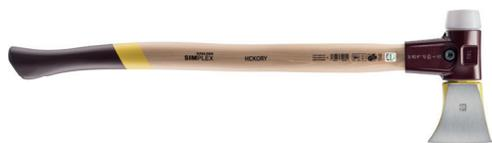
Hacha seccionadora y mallo no férrico en una misma herramienta, hoja del hacha forjada y endurecida, afilada y pulida, manguito protector del mango, boca de superplastic, certificado KWF, todos los componentes son reemplazables
