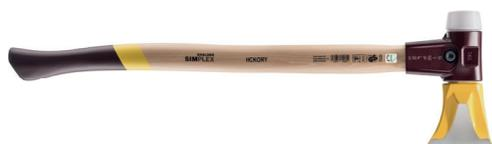
Hacha seccionadora y mallo no férrico en una misma herramienta, hoja del hacha forjada y endurecida, afilada y pulida, manguito protector del mango integrado en el cuerpo, boca de superplastic, certificado KWF, todos los componentes son reemplazables, alta eficiencia seccionadora
